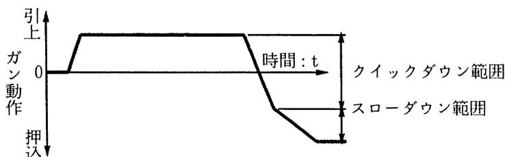
①クイックダウン範囲の調整は、下図のようにオイルダンパーの調整ナットを緩めてオイルダンパーの位置を決めます。ガンを手で引き上げて離れた時、オイルダンパーのピストンとストップピンが当たるまでの距離がクイックダウン範囲です。
